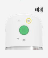
Die Anzeigeleuchte BATTERIESTAND NIEDRIG leuchtet leuchtet einmal alle fünf (5) Sekunden auf.
