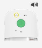
Die Anzeigeleuchte UNDICHTIGKEIT leuchtet 1x pro Sekunde auf. Die Pumpe gibt wiederholt einen Alarm (Signalton) aus und geht dann in den Pausenmodus.
