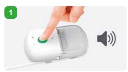
Halten Sie die Pumpe an, indem Sie auf den grünen Startknopf drücken und ihn nach zwei (2) Sekunden wieder loslassen. Die Pumpe gibt zwei Signaltöne aus, um zu bestätigen, dass sie sich im Pausenmodus befindet
