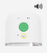
Die Anzeigeleuchte BLOCKADE leuchtet 1 x pro Sekunde auf. Die Pumpe gibt wiederholt einen Alarm (Signalton) aus und geht dann in den Pausenmodus.
