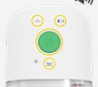
Alle Anzeigeleuchten blinken in schnellen Intervallen. Die Pumpe gibt wiederholt einen Alarm (Signalton) aus und geht dann in den Pausenmodus.
