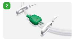
Schieben Sie die Schlauchschellen bis nahe an die grünen Anschlüsse und drücken Sie beide Klemmen über die Schläuche, um sicherzustellen, dass es beim Trennen nicht zu einer Undichtigkeit kommt.
